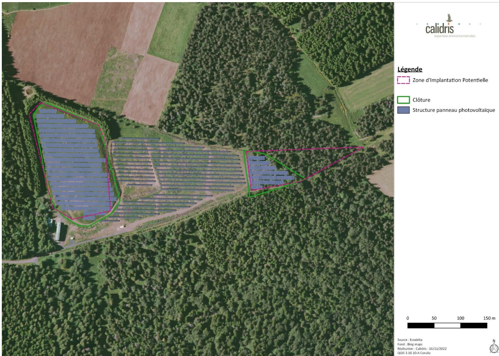
Carte 43 : Variante d'implantation des panneaux photovoltaïques n°1
